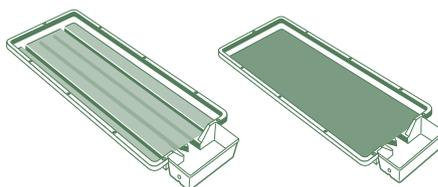
Un tapis capillaire est posé au fond du plateau du système Tray2Grow et bordé dans les deux canaux situés le plus à l'extérieur.
