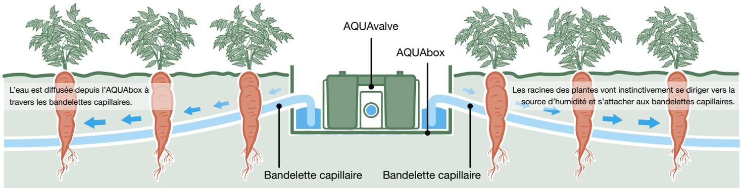
L'AQUAbox intègre la technologie AQUAvalve utilisée sur toute la gamme AutoPot. Cette solution alternative permet d'irriguer de vastes zones de culture plutôt qu'un pot à la fois. Idéale pour des bandes de terre surélevées ou des pains de fibre de coco ou terre de forme allongée. L'AQUAbox est installée directement dans le sol et distribue l'eau et les nutriments aux plantes environnantes en utilisant ses bandes de fibre géotextile (diffusion par capillarité).
