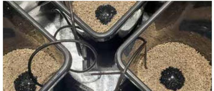
Placez le AirDome au fond du pot et le connecter à une pompe à air.
