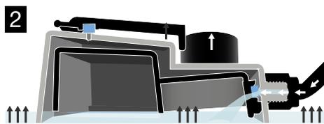
L'air piégé dans le corps principal ne peut s'échapper tant que le silicone du flotteur supérieur crée un joint d'étanchéité sur le corps principal et l'eau continue d'entrer dans le plateau tant que le flotteur interne est incapable de s'abaisser en raison de l'air piégé.
