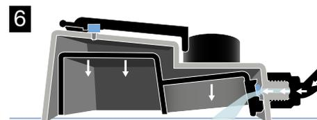
Une fois que le niveau de la solution nutritive baisse en dessous du corps principal de l'AQUAvalve, la tension de surface de l'eau autour du corps principal de l'AQUAvalve va se rompre. Cette étape peut prendre jusqu'à une heure. Le vide dans le corps principal est ensuite relâché et le flotteur interne s'abaisse dans une position où l'orifice d'entrée peut être dégagé et le processus de remplissage recommence.
